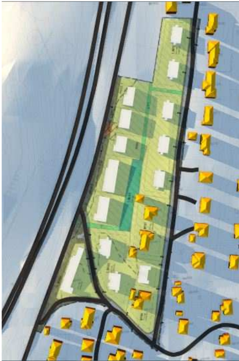
Sol og skygge diagram den 21. juni kl 18.45 viser skygge fra ny bebyggelse i hagene til eksisterende boliger i Lyngveien.
