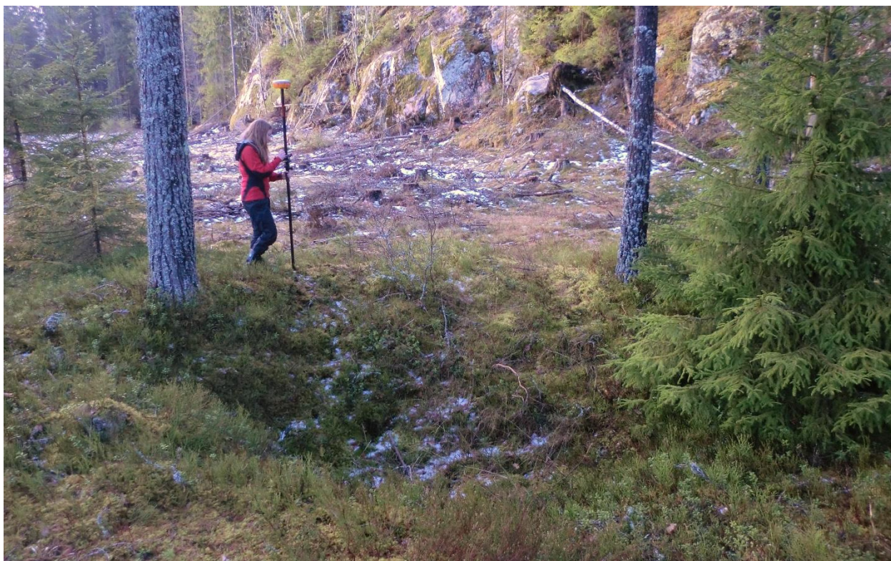
Figur 1: Innmåling av kulturminner ble gjort med en avansert GPS (C-pos). Her måles fangstgropen179841 på Markmoen på Snarum inn.
