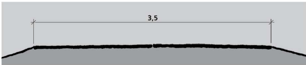
Figur C.20: Tverrprofil A1, 3,5 m vegbredde (mål i m)
