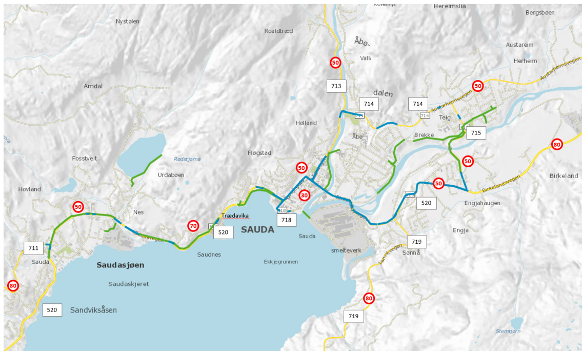
Figur 25: Gang- og sykkelveier (grønt) og fortau (blått) tilknyttet fylkesveinettet i Sauda. I tillegg er det fortau langs flere av de kommunale veiene, særlig i sentrum. Fartsgrensener er angitt. Kartet er utarbeidet med utgangspunkt i opplysninger i vegkart.no
